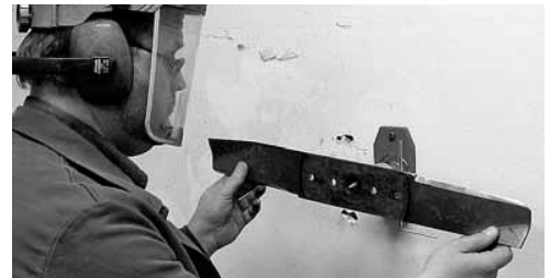
Bild 5: Mit diesem Gerät wird geprüft, ob das Messer nach dem Schleifen keine Unwucht hat.
