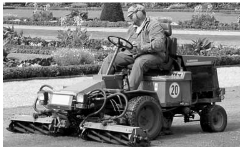
Bild 1: Der Fahrersitz von Aufsitzmähern ist höhenverstellbar und lässt sich auch dem Gewicht des Fahrers anpassen.
