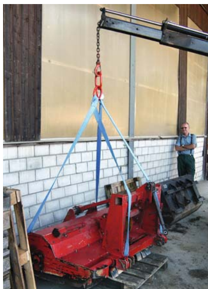
Mit Gehängen können Lasten sicher angehoben werden. Die Nutzlast des Kranes darf in keinem Fall überschritten werden.
