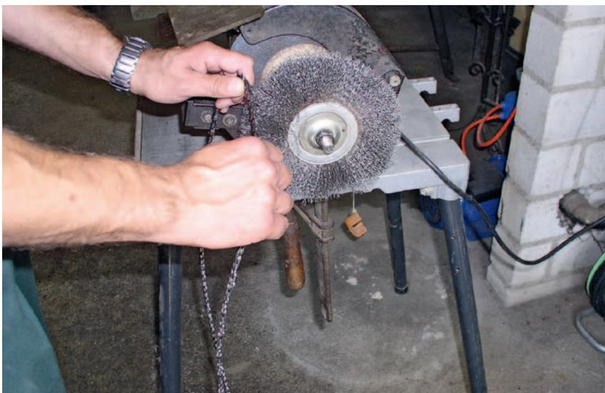
**Nachgestellte Unfallsituation: Beim unsachgemässen Reinigen wurde die Motorsägenkette von der Drahtbürste erfasst.**
